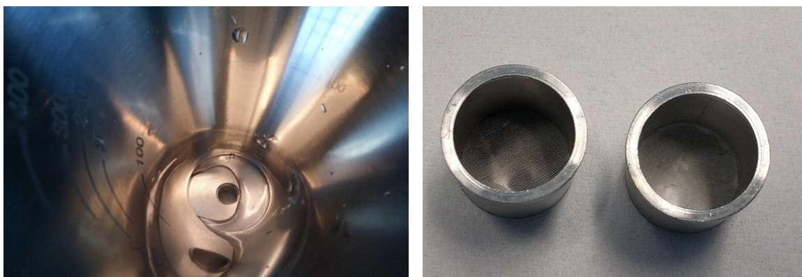
Abbildung 2-15: Filtrationseinheit mit zurückbleibendem Probenrest (links); beladener und unbeladener Mikrofiltertiegel (rechts)
